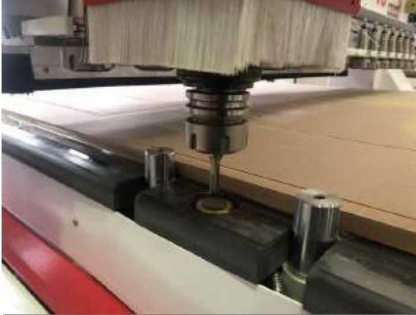
Otomatik takım ayar sensörü ve konumlandırma silindiri
