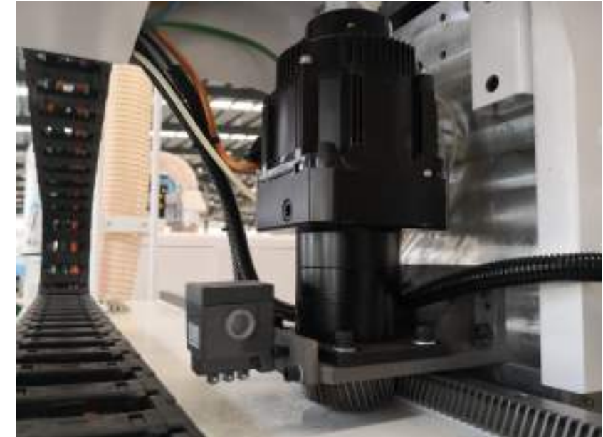
Tayvan AC Servo motor, Japon redüktör
