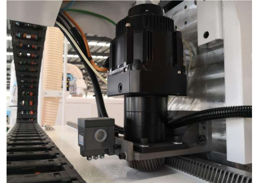
Tayvan AC Servo motor, Japon redüktör
