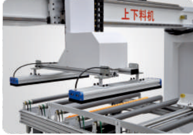
Portal tipi yükleme ve vakum emme sistemi
