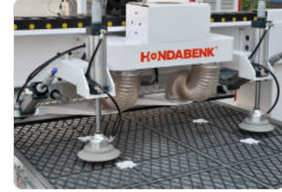
Otomatik besleme sistemi, hızlı ve verimli üretim sağlar
