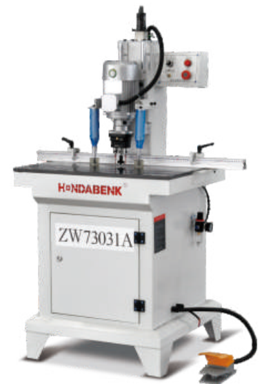
ZW73031A | Otomatik Menteşe Delme Makinesi
