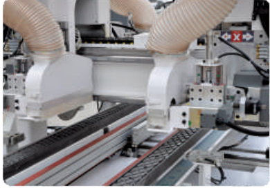
Boyuna sabit güçlü ana ve yardımcı testereler
