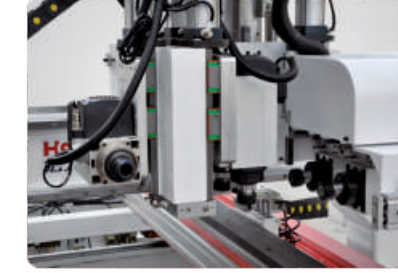
Kilit yuvası ve kanal işleme ünitesi
