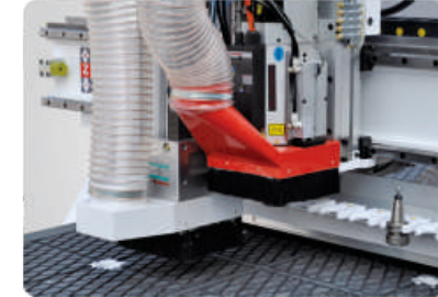
16 bıçaklı otomatik değişirme sistemi
